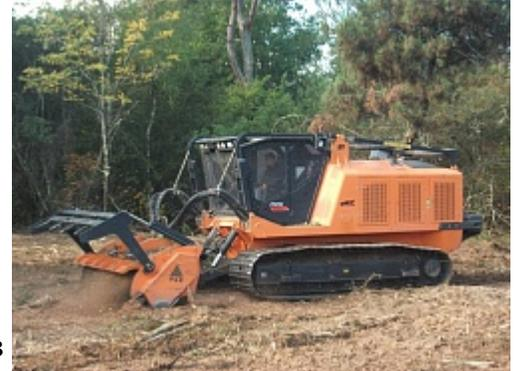
Чрезвычайно низкое давление на грунт  $0,40 \text{ кг/см}^2$  - 5,7 пси - одна из выдающихся характеристик этого гусеничного транспортера таких размеров. Простота техобслуживания, комфортность и эргономичный дизайн дополняют исключительные технические характеристики RT-600.
